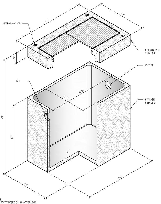
\*850 GALLON CAPACITY BASED ON 55" WATER LEVEL
